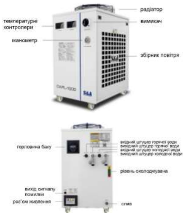
Малюнок 1 - Компонування системи охолодження.
