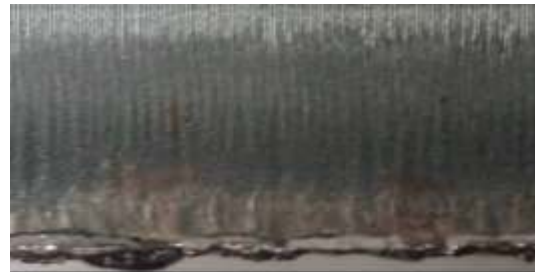
НЕПРАВИЛЬНЕ ЦЕНТРУВАННЯ, СТОРОНА 2
