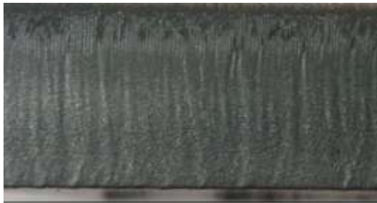
НЕПРАВИЛЬНЕ ЦЕНТРУВАННЯ, СТОРОНА 1
