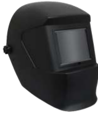
Рис. 1 – З варювальна маска зі ступенем захисту (рівень затемнення): DIN 4-5-6-7-8 - світлий стан; DIN 9-10-11-12-13 – темний стан.
